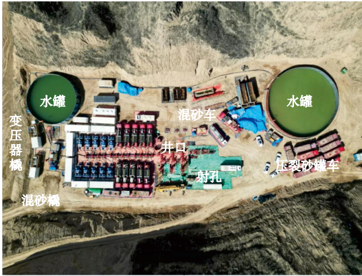
图1 吉深11-7A平台井场平面图
